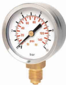
MR40 - MR50 - MR63: MANÓMETRO CAJA PLÁSTICO SALIDA RADIAL -20 +60°C P >2,5 Bar >1,6 Bar (bajo pedido) Grado P. IP43
